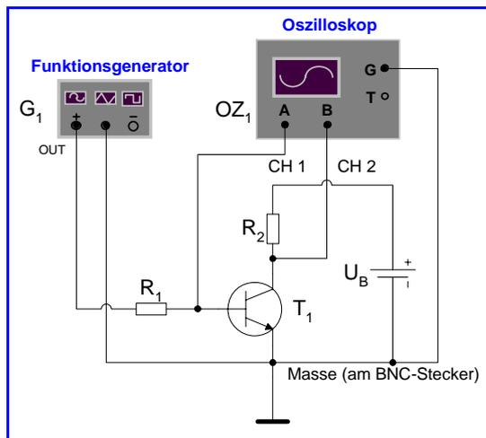
**Werte:**  $R_1 = 82 \text{ k}\Omega$  (grau, rot, orange, gold),  $R_2 = 1,5 \text{ k}\Omega$  (braun, grün, rot, gold),  $T_1 = \text{Si-npn-Transistor} = \text{BC548C}$  oder BC 337-25,  $G_1 = \text{Rechteckgenerator}$ ,  $OZ_1 = \text{Oszillograph}$ ,  $+U_B = +12\text{V}$ , CH 1 = 1. Eingang des Oszillographen, CH 2 = 2. Eingang des Oszillographen, BNC-Kabel: roter Draht = Signal, schwarzer Draht = Masse
