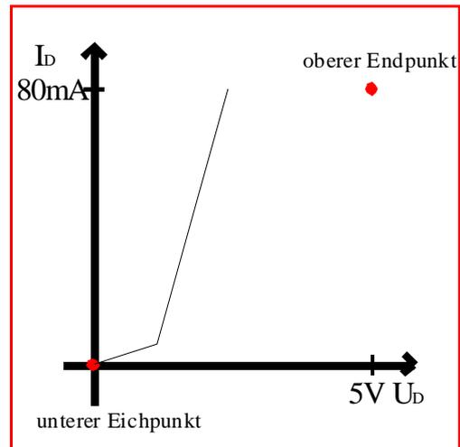
**Werte:**  $R_1 = 1 \Omega$  (braun, schwarz, schwarz, silber, braun [dick]),  $D_1 =$  Si.-Diode 1N4007 (Plaste), Si.-Diode 1N4148 (Glas) - Strich =Katode, Leuchtdiode rot, grün, gelb (rosa),  $G_1 =$  Dreieckgenerator,  $OZ_1 =$  Oszillograph
