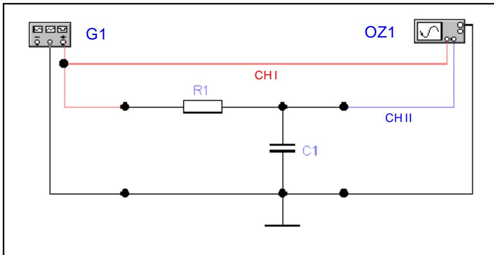
**Werte:**  $R1 = 1,5 \text{ k}\Omega$  (braun, grün, rot, gold),  $C1 = 100 \text{ nF}$ ,  $G1 = \text{Sinusgenerator}$ , Kanal 1 = Vertikaleingang (Y - Eingang), Kanal 2 = Horizontaleingang des Oszillographen (X - Eingang)
