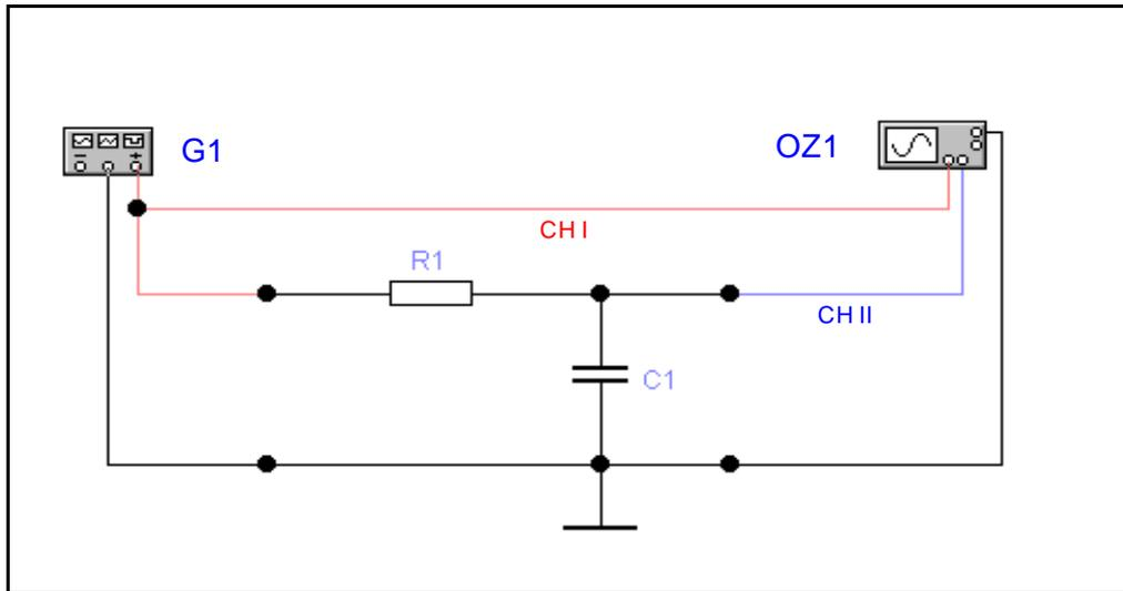
**Werte:**  $R1 = 1,5 \text{ k}\Omega$  (braun, grün, rot, gold),  $C1 = 100 \text{ nF}$ ,  $G1$  = Rechteckgenerator, Kanal 1 = erster Vertikaleingang (erster Y - Eingang), Kanal 2 = zweiter Vertikaleingang des Oszillographen (zweiter Y - Eingang)
