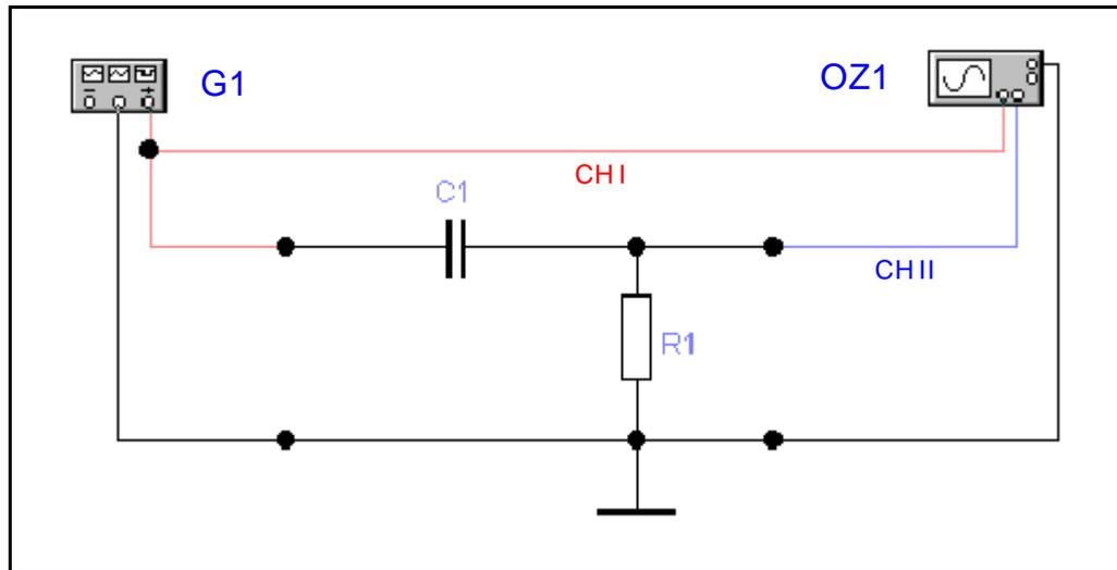
**Werte:**  $R1 = 1,5 \text{ k}\Omega$  (braun, grün, rot, gold),  $C1 = 100 \text{ nF}$ ,  $G1$  = Sinusgenerator, Kanal 1 = erster Vertikaleingang (erster Y - Eingang), Kanal 2 = zweiter Vertikaleingang des Oszilloskopfen (zweiter Y - Eingang)
