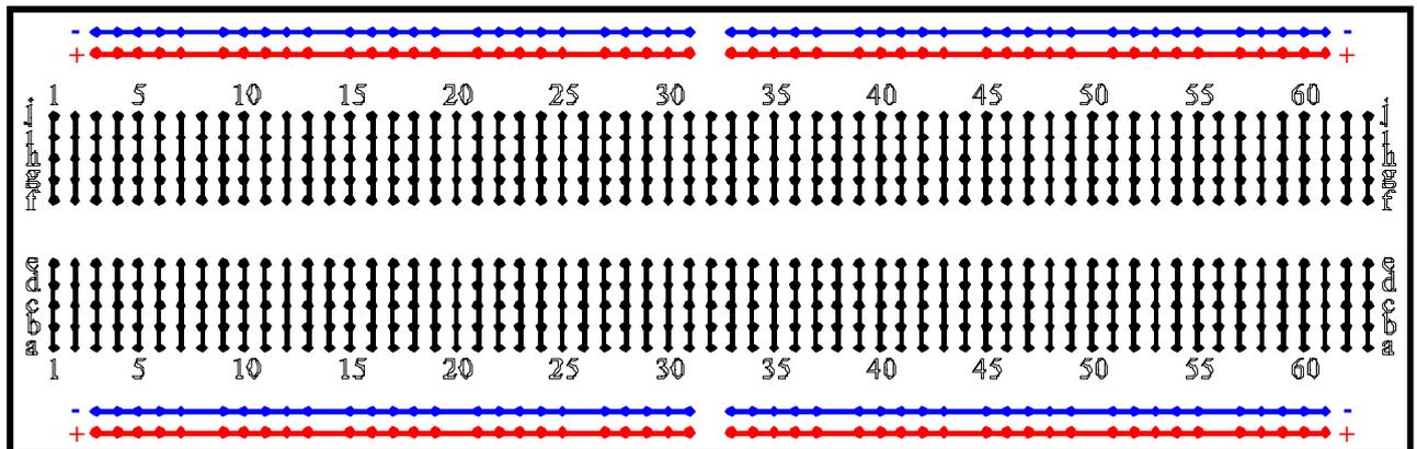
Die Abgreifklemmen der Löcher sind nach folgendem Schema miteinander verbunden., Die oberen und unteren horizontalen Verbindungen sollten vorzugsweise für Versorgungsgleichspannungen bzw. Masse verwendet werden.
