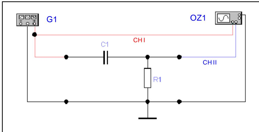
**Werte:**  $R1 = 1,5 \text{ k}\Omega$  (braun, grün, rot, gold),  $C1 = 100 \text{ nF}$ ,  $G1$  = Sinusgenerator, Kanal 1 = Vertikaleingang (Y - Eingang), Kanal 2 = Horizontaleingang des Oszillographen (X - Eingang)
