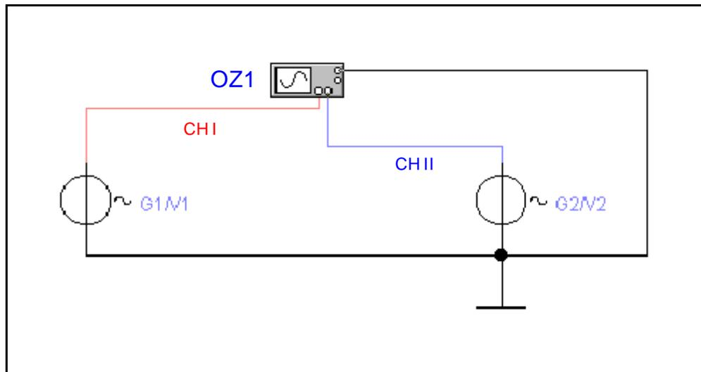
**Werte:** G1 = Sinusgenerator 1, G2 = Sinusgenerator 2, Kanal 1 = Vertikaleingang (Y-Eingang), Kanal 2 = Horizontaleingang des Oszilloskops (X-Eingang)
