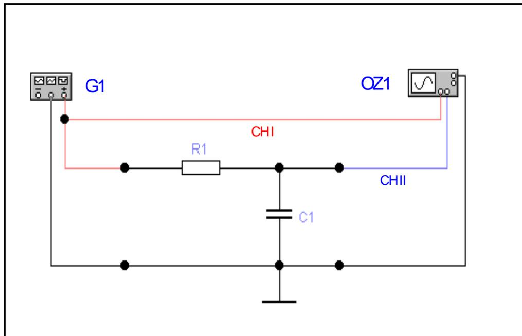
**Werte:**  $R1 = 1,5 \text{ k}\Omega$  (braun, grün, rot, gold),  $C1 = 100 \text{ nF}$ ,  $G1 = \text{Sinusgenerator}$ , Kanal 1 = erster Vertikaleingang (erster Y - Eingang), Kanal 2 = zweiter Vertikaleingang des Oszillographen (zweiter Y - Eingang)
