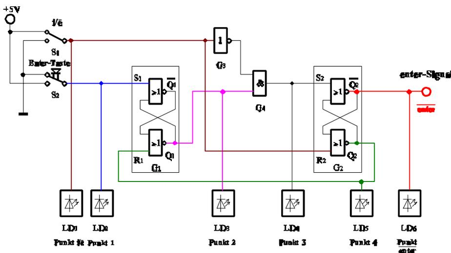
**Bauen Sie die Schaltung entsprechend der Prinzipschaltung mit RS-FlipFlops mit Hilfe des Programms Multisim auf:**
