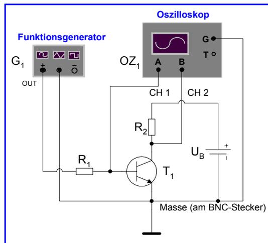
Werte:  $R_1 = 82 \text{ k}\Omega$  (grau, rot, orange, gold),  $R_2 = 1,5 \text{ k}\Omega$  (braun, grün, rot, gold),  $T_1 = \text{Si-npn-Transistor BC548C}$ ,  $G_1 = \text{Rechteckgenerator}$ ,  $OZ_1 = \text{Oszillograph}$ ,  $+U_B = +12\text{V}$ , CH 1 = 1. Eingang des Oszillographen, CH 2 = 2. Eingang des Oszillographen, BNC-Kabel: roter Draht = Signal, schwarzer Draht = Masse ( $\perp$ )
