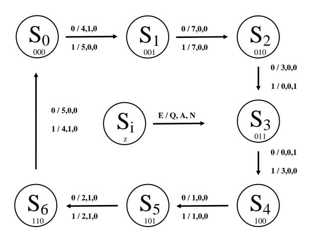
3. Erstellen Sie die Übergangs- und Funktionstabelle für die Realisation mit D-FlipFlops.
