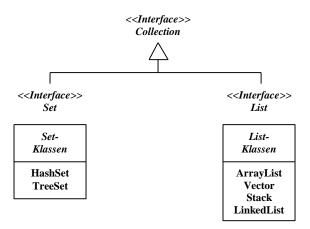
Im Paket sind bereits verschiedene Implementierungen der dort definierten Interfaces enthalten. Alle das Interface Collection implementierende Klassen nennt man Collection-Klassen. Die Collection-Klassen ArrayList, LinkedList, Vector und Stack implementieren das Interface List und werden deshalb auch als List-Klassen bezeichnet. Das Interface Set wird u.a. von den Set-Klassen HashSet und TreeSet implementiert.
