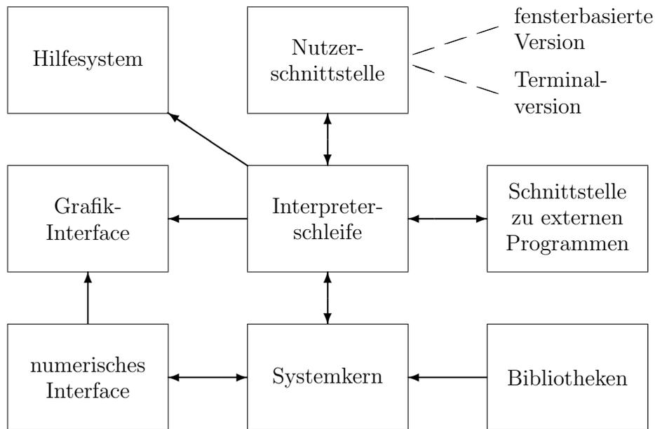
**Bild 1:** Prinzipieller Aufbau eines Computeralgebra-Systems
