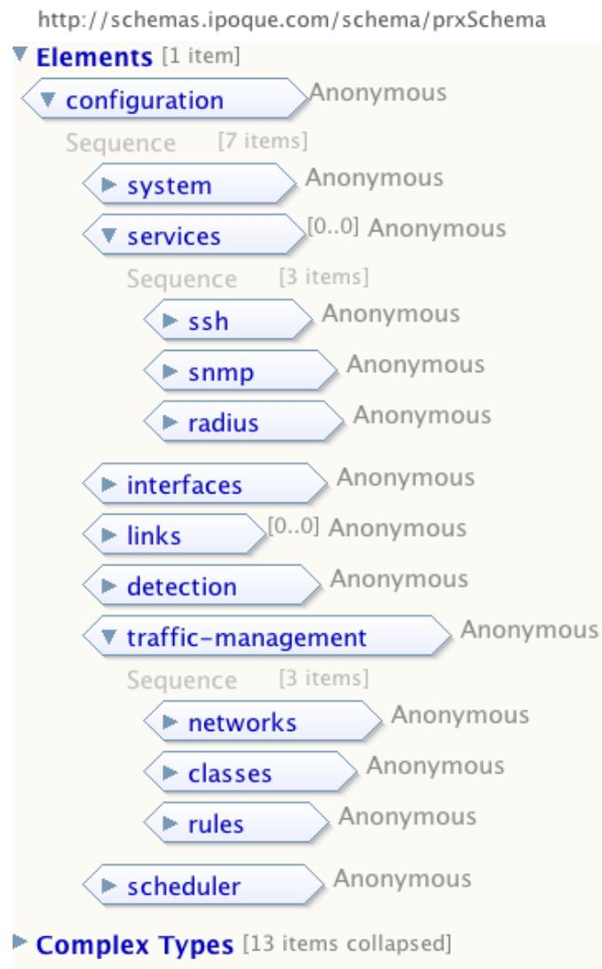
Abbildung 13: Torben / PRX Konfigartionsschema (Design)
