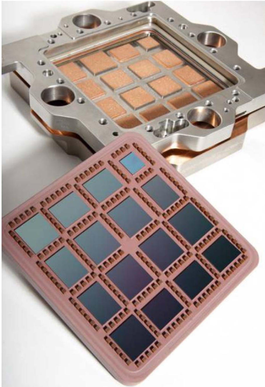
Abb. 4.2.2 Halierung des z9 Multichip Modules
