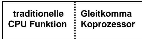
Beim Intel 80486 und Pentium/AMD ist die Gleitkommafunktion in das Micro-Prozessor Chip integriert
