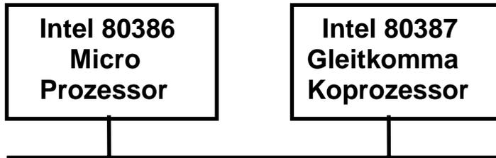
Ohne 80387 verursacht die Ausführung eines Gleitkomma-Maschinenbefehls eine Programmunterbrechung. Die Unterbrechungsroutine führt die Gleitkommaoperation aus.
