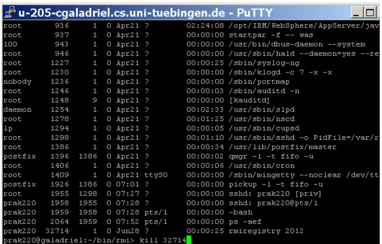
Wenn bei der Ausführung des Kommandos eine Fehlermeldung erscheint, kann es sein, dass rmiregistry bereits läuft. Dies kann mit dem Kommando `ps -aef` überprüft werden. Wenn ja, notieren Sie die entsprechende PID und beenden Sie den rmiregistry-Prozess mit dem Command `kill [pid]`; in dem folgenden Beispiel also mit `kill 32714`.
