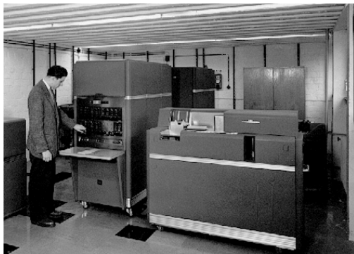
Technische Hochschule Darmstadt, Institut für praktische Mathematik, Prof. Dr. Walther. Ab 1957 ausgestattet mit IBM 650 -im Bild-, Mitarbeiter an der Bediener-Konsole der zentralen Recheneinheit, vorne rechts der Kartenleser/Stanzer, im Hintergrund die E/A-Steuerereinheit. 1953
