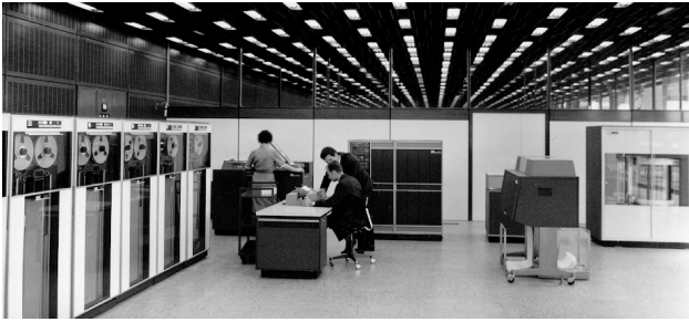
IBM Rechenzentrum Böblingen, IBM System 1401 , v. links nach rechts: sechs Magnetbandeinheiten 729, Karteneinheit 1402, Abfragekonsole 1407, Zentrale Recheneinheit mit Hauptspeicher 1401, Schnelldrucker 1403 und dahinter die Hauptspeichererweiterung auf 16 000 Stellen. Ganz rechts die Plattenspeichereinheit 1405. 1959
