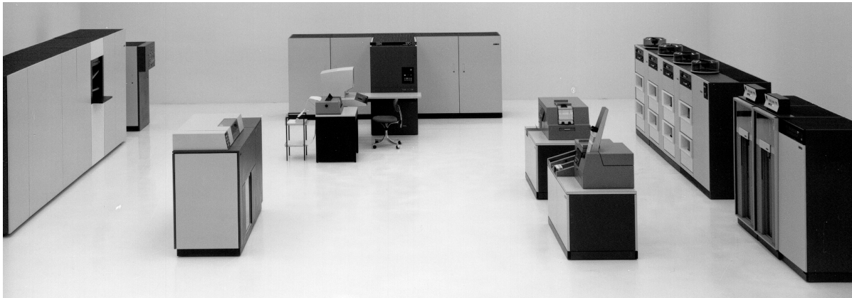
IBM /370 Modell 158, in der Mitte hinten die Prozessoreinheit, davor die Bedienungskonsolle mit Monitorbildschirm.
