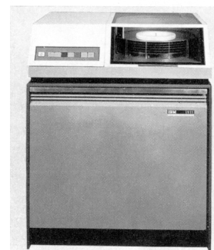
Plattenspeicher IBM 1311 mit auswechselbarem Plattenstapel IBM 1316 mit 2 Mio alphanumerischen Zeichen Speicherkapazität. Die durchschnittliche Zugriffszeit beträgt nur 150 ms. Angekündigt mit IBM System 1440 in 1962. 1962
