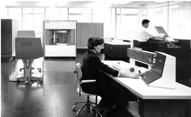
Rechenzentrum des Postscheckamtes Hamburg IBM System 1410 in 1962, von links nach rechts: Zentrale Recheneinheit mit Hauptspeicher 1411, Schnelldrucker 1403, Magnetplattenspeicher 1405, dahinter die Kanaleinheit, ganz vorne die Systemsteuerkonsole, rechts dahinter die Karteneinheit 1402. Rechts davon, nicht sichtbar, mehrere Magnetbandeinheiten 729. 1960
