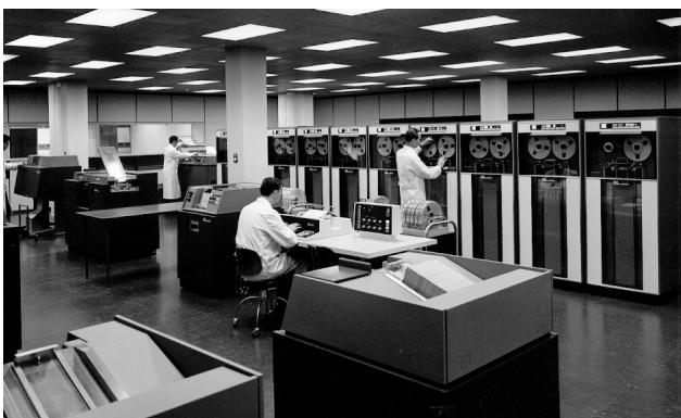
Rechenzentrum des Versandhauses Neckermann Frankfurt, der erste IBM 7070 Großrechner Europas geht 1960 in Betrieb. Vorne in der Mitte der Systemoperator am Steuerpult, rechts hinten der Bandoperator an einer Magnetbandeinheit IBM 729. Die Datenumsetzung von Urbelegen auf Magnetband und die Ausgabe auf Schnelldruckern besorgten mehrere IBM 1401 Systeme. Der Datenverkehr zwischen den Systemen erfolgte noch durch Magnetbänder. 1959
