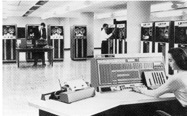
Die Großrechenanlage IBM 705 III der Farbwerke Höchst AG ging 1957 in Betrieb. Die Anlage bestand aus 24 Einheiten, sie beanspruchten eine Raum-Grundfläche von rund 150 qm, der elektrische Anschlußwert lag bei über 100 kW. Im Vordergrund die Operatorkonsole. 1957
