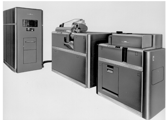
Rechner IBM 628 (links), IBM 421k (Mitte) und Lochkarten-Abfühl- und Stanzeinheit IBM 565 (rechts).
