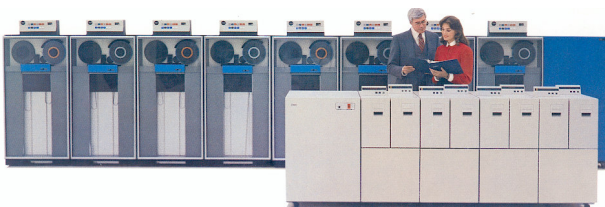
Magnetband-Subsystem IBM 3480 (1984). Im Vordergrund links die Steuereinheit mit vier Doppelkassetteneinheiten. Im Hintergrund: die bisherigen Einheiten mit Bandspulen, die Stellfläche wurde habbiert.
