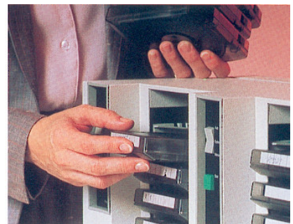
Automatischer Kassettelader, optional zu 3480 (1986). Auf Systemanforderung wurde eine Bandkassette in 4 Sekunden geladen.
