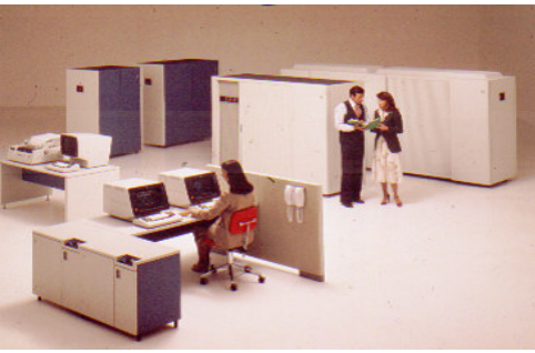
Großrechner IBM 3081 (1980), Prozessoreinheit 3081, Prozessorsteuereinheit 3082, 2 Kühleinheiten 3087, Netzfrequenzwandler 3089, Systemsteuerkonsole 3279 mit Steuereinheit 3274.
