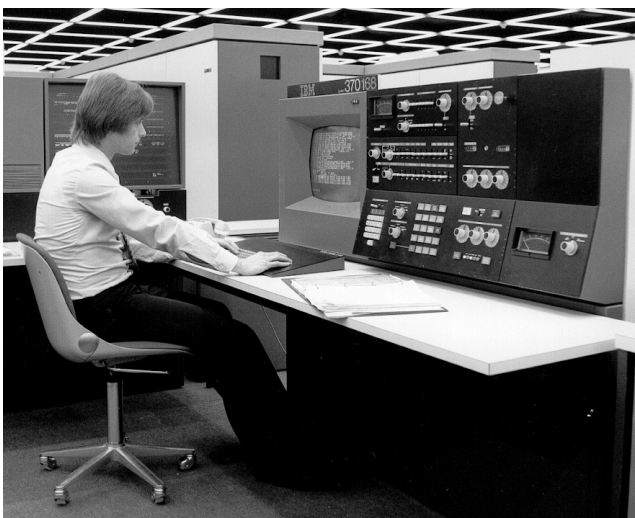
Modell 168, System-Bedienungskonsolle, teils mit herkömmlichen Anzeigelampen, Schaltern und Drehknöpfen, doch zusätzlich einem Monitorbildschirm mit Tastatur.
