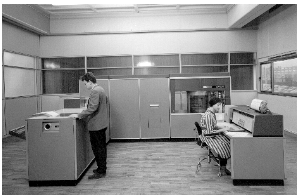
IBM 305 RAMAC System. Der erste industriell gefertigte Computer mit Direct Access Storage im Bild rechts hinten, rechts vorne die Operatorkonsole, links vorne der Drucker, im Hintergrund links die zentrale Recheneinheit. 1956
