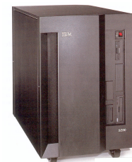
S/390, Server Multiprise 3006 (1998), in Neben-Tisch-Bauweise, 52 cm breit, 111 cm tief und 82 cm hoch Quelle: IBM S/390 Bulletin, 11-1998
