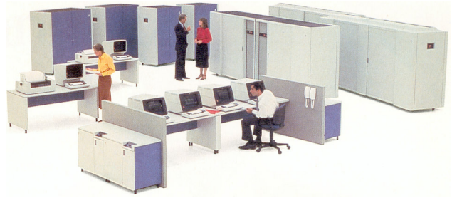
Großrechner Multiprozessor-Komplex IBM 3084 (1982). Prozessoreinheit 3084, Prozessorsteuereinheit 3082, 2 Kühleinheiten 3087, Netzfrequenzwandler 3089, Datensichtgeräte 3278 und weitere der System-Steuerkonsole.
