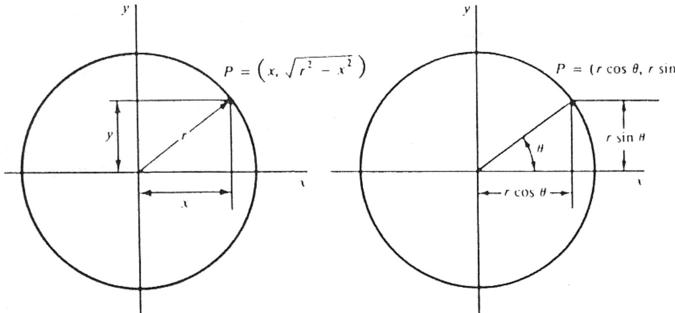
Nachteil: Beide Methoden zur Kreisdarstellung sind rechenaufwändig und erfordern höhere Rechenoperationen.
