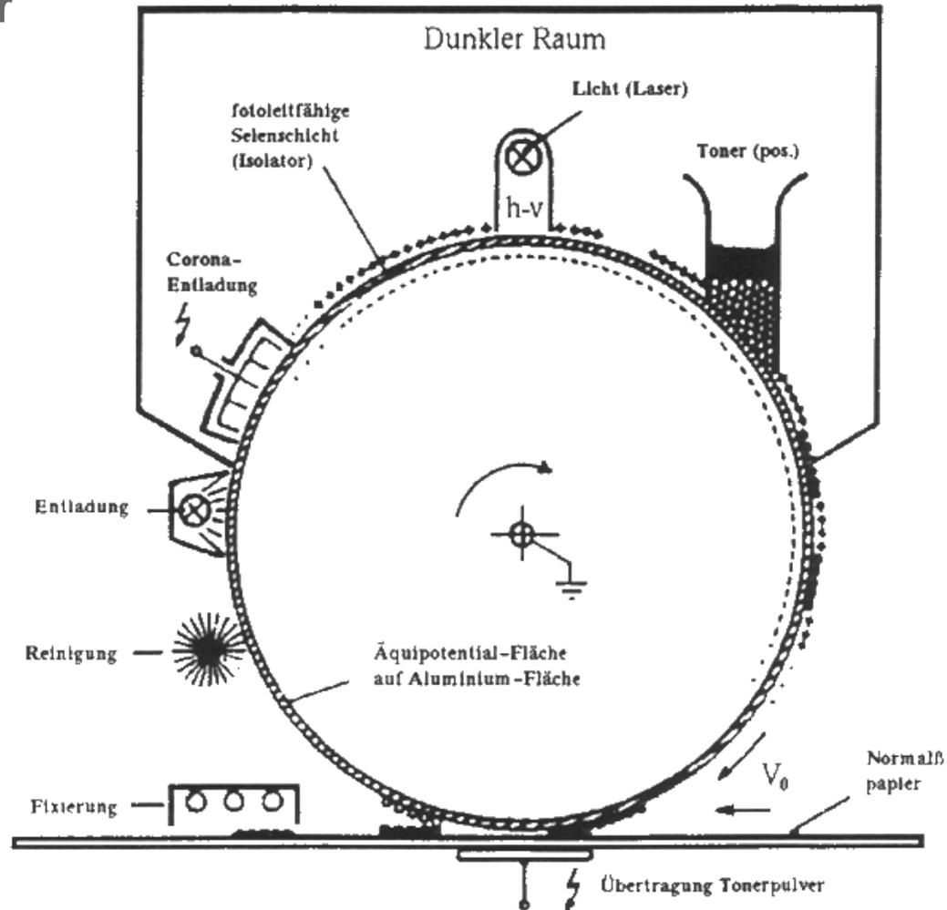
Abb.: Prinzip des xerographischen Druckverfahrens
