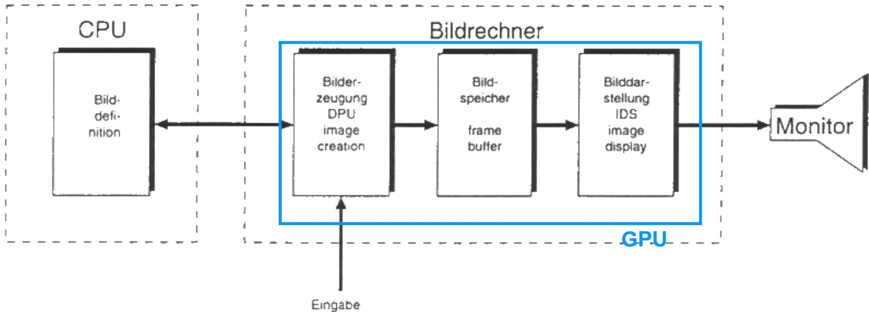
Abb.: Hauptkomponenten eines klassischen Rasterdisplays
